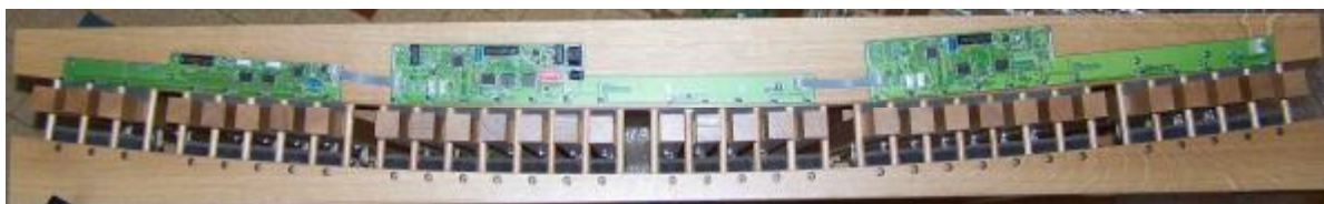
Interface Midi pour pédalier, gérant également pédales expressives ou crescendo, ainsi que 24 pistons lumineux.
